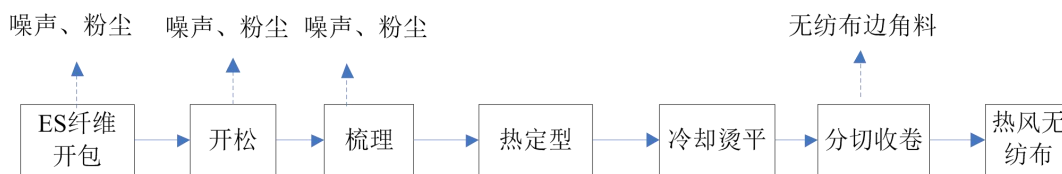
图 3.4.1 热风无纺布生产工艺流程图
